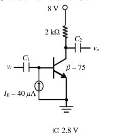
29 圖示電晶體放大器之固定偏壓電路中, $V_{ECQ}=2$  V。若要將 $V_{ECQ}$  改成 6 V,電晶體之  $\beta$  值應改為多少?(電晶體其他特性參數不變。)
