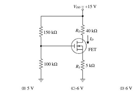
28 圖示的電晶體放大電路,求輸出火。不失真之最大振幅約為多少?
