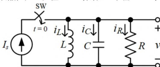
36 如圖所示之  $RLC$  串聯電路, 當  $\omega = 0$  時, 電阻上的電壓  $v_R$  為多少伏特?
